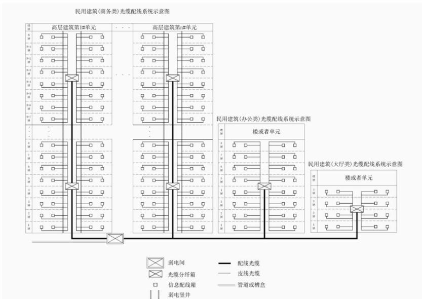
图4 民用建筑光缆配线系统示意图
